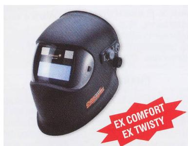
**OPTREL ORION OSE 9-13** La nuova esclusiva tecnologia di sensore intelligente della maschera Optrel Orion Ose regola automaticamente il livello di graduazione da DIN 9-13 in funzione dell'intensità luminosa dell'arco. L'utilizzatore ha la possibilità di mettere a punto questa regolazione automatica di +/- 1 livello di gradazione oppure escludere la regolazione automatica e passare al tradizionale manuale. Campo di regolazione automatica o manuale: 9-13 DIN
