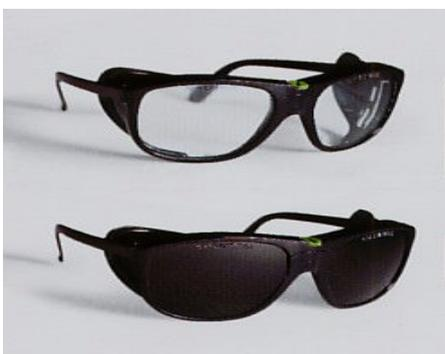
**Occhiale** con ottica trasparente in policarbonato per la protezione da impatto accidentale oppure con ottica inattiva verde per la protezione dalle radiazioni di saldatura. Montatura in plastica ultraleggera, lenti sagomate intercambiabili tramite vite sul nasello, protezioni laterali rimovibili e stanghette con foro per lacci.
