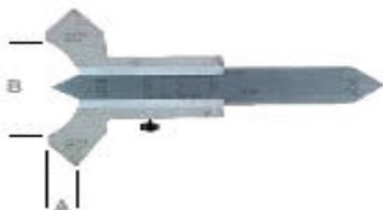
Calibro per spessori di saldatura, acciaio inox, scala cromata opaca, angoli 60°, 70°, 80°, 90°, lettura 0,1 mm. Astuccio in similpelle.
