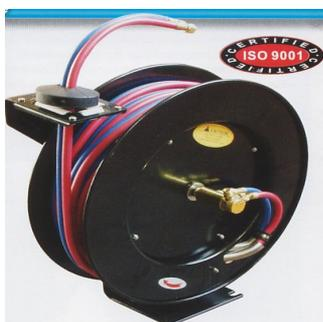
Struttura in acciaio molto resistente, verniciata con prodotti anticorrosione, giunto girevole in ottone forgiato. Sigillatura con doppio "O-Ring" per impedire perdite di gas. Numerose posizioni di arresto per garantire una facile regolazione della lunghezza del tubo. Le scanalature dell'aspo assicurano una corretta installazione dei tubi. Tubo esterno di collegamento di 90 cm.
