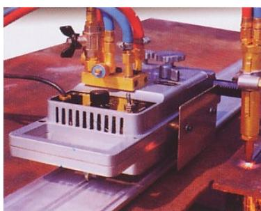
**Macchina portatile per ossitaglio. Tagli lineari, circolari e a smusso.** Equipaggiata anche con due cannelli. Funziona a 42 V. C.C. con trasformatore esterno. Possibilità di essere equipaggiata con motore a velocità adatta al taglio plasma. Tagli circolari da 75/1300 mm. Velocità taglio regolabile da 75 a 950 mm/min.
