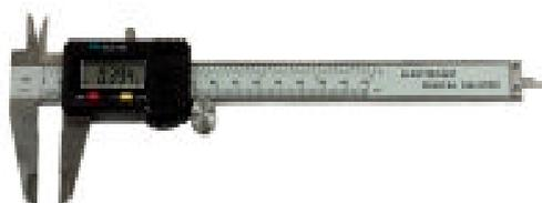
Inox temprato, lettura 0,01 mm, **4 funzioni di misura**, precisione + 0,02 mm, ripetibilità 0,01 mm, azzeramento misure comparative (+-), uscita stampante, conversione in mm/inch, autospegnimento automatico, astuccio in ABS
