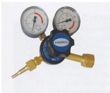
**Riduttore di pressione:** Corpo massiccio in ottone forgiato, coperchio verniciato nero antigraffio, sede alta pressione a capsula in PTFE (Teflon) con filtro sinterizzato in bronzo, valvola di sicurezza interna per scarico sovrappressione nei modelli per gas compressi, manometri con cassa in acciaio trattata con vernice antigraffio nera che non richiede cuffie di protezione.
